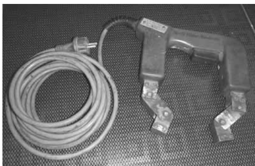
Rys. 2. Defektoskop jarzmowy AC 230 do badań MT Fig 2. AC 230 flow detector for MT testing
