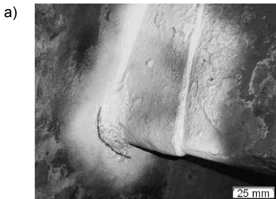
Rys. 5. Miejsca pęknięć łączenia łopat wirnika z płytą czołową: a) nr 1, b) nr 4
