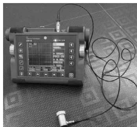
Rys. 4. Defektoskop ultradźwiękowy USM 35 do badań UT Fig 4. USM 35 ultrasonic flaw detector for UT testing
