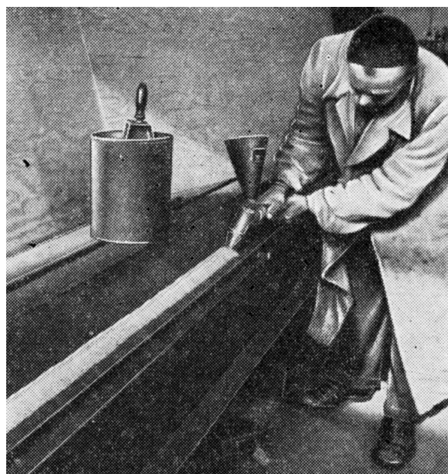
Rys. 15. Spawacz przy pracy urządzeniem AS3-500 [23] Fig. 15. Welder at work with the AS3-500 device [23]
