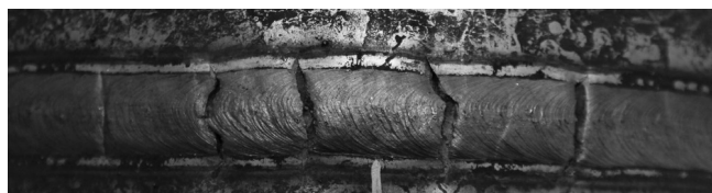
Rys. 7. Przykładowy pozytywny wynik próby SEP 1390 Fig. 7. An example of a positive result of the SEP 1390 test
