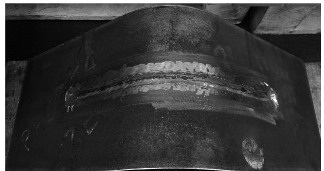
Rys. 3. Przykładowy pozytywny wynik próby Kommerella o grubości 40 mm po zginaniu o kąt 40°
