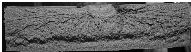
Rys. 8. Przełom płyty z negatywnym wynikiem próby SEP 1390 Fig. 8. Breakthrough of the plate with a negative result of the SEP 1390 test
