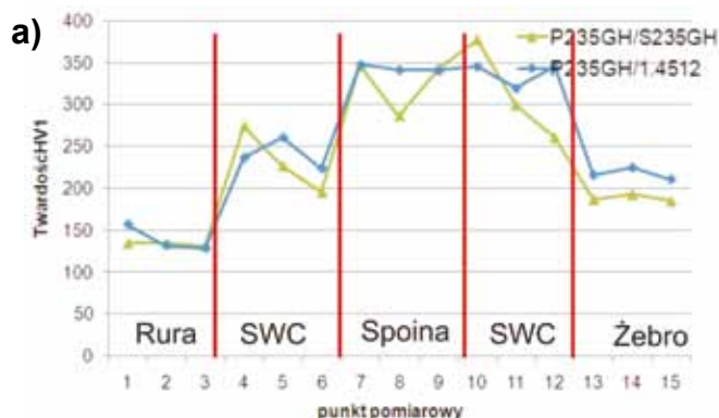
Rys. 10. Rozkład twardości w złączu rura-żebro wykonanym w technologii laserowej (a), wyniki technologicznej próby odrywania żebra (b) Fig. 10. Hardness distribution in the laser beam welded pipe-fin joint (a), results of technological removal test of fin and pipe (b)
