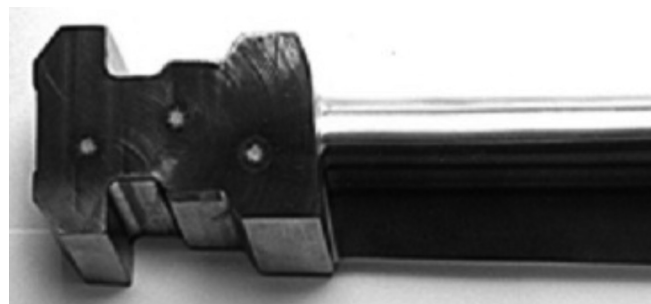
Rys. 4. Widocznie 3 przypalenia spektrometrem iskrowym na powierzchni łopatki
