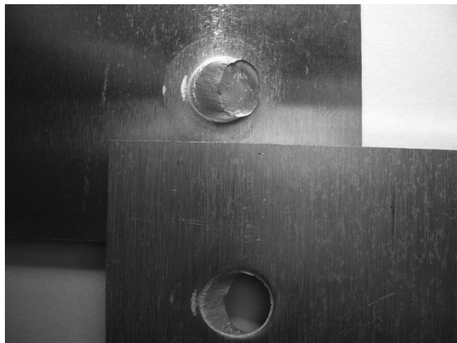
Rys. 6. Przykładowe złącze dwóch blach gatunku EN AW-1050A o grubości 3 mm, po badaniu wytrzymałości na ścinanie
