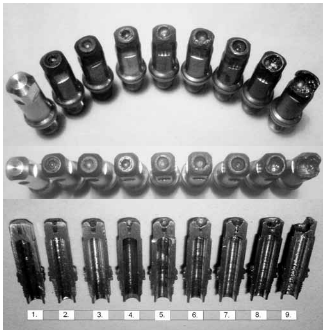
Rys. 2. Trwałość elektrody – od stanu nominalnego do zużycia Fig. 2. Durability of an electrode – from novelty up to scrapping
