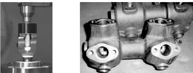
Rys. 17. Napawanie plazmowe proszkowe warstwy wierzchniej uszczelniającej gniazdo zaworu
