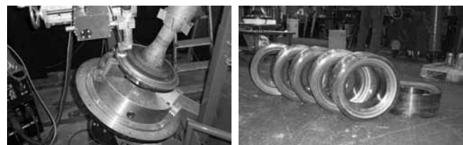
Rys. 13. Napawanie plazmowe proszkowe zaworu i gniazd zaworowych silników okrętowych
