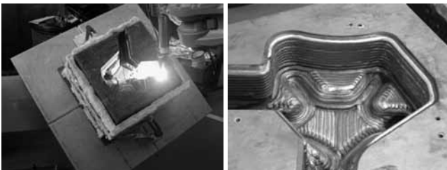
Rys. 16. Napawanie plazmowe proszkowe narzędzi do obróbki plastycznej metali
