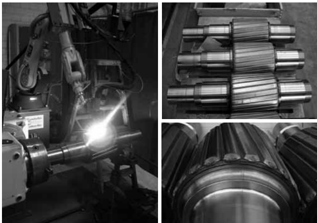
Rys. 22. Przykład zrobotyzowanego spawania plazmowego proszkowego
