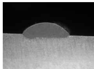
Rys. 3. Makrostruktura napoiny wykonanej plazmowo proszkowo na stali 0H18N9 proszkiem kobaltowym podawanym przed łuk, I = 80 A, wymieszanie z materiałem rodzimym 16%, pow. 4 \times [6] Fig. 3. Macrostructure of PPTA hard-facing on the 0H18N9 steel using delivered before arc cobalt powder, I = 80 A, 16% materials intermix, magn. 4 \times [6]
