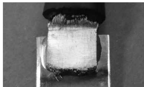
Fig. 3. Resistance brazing on a resistance-compact strand, cross-section area 50 mm 2 Rys. 3. Luto-zgrzewana zbrykietowana oporowo końcówka liny miedzianej o przekroju 50 mm 2
