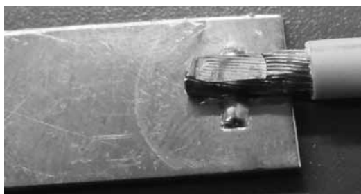
Fig. 2. Resistance projection weld on a resistance-compact strand, cross-section area 6 mm 2 Rys. 2. Zgrzeina oporowa zbrykietowanej oporowo końcówki liny miedzianej o przekroju 6 mm 2
