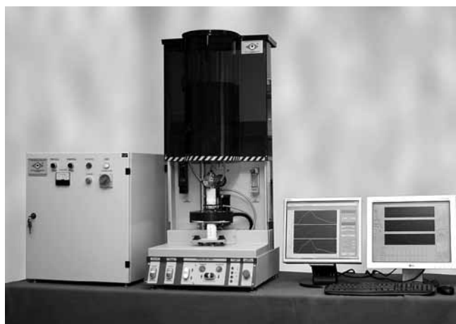
Rys. 1. Widok ogólny stanowiska do badania przemian fazowych w stalach w warunkach spawalniczych
