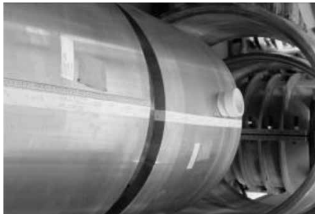
Rys. 6. Kołpaki wirników generatorów
