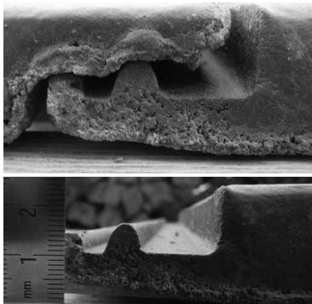
Rys. 9. Znaczna deformacja dachówki, wygięcie z płaszczyzny wynosi 5 mm
