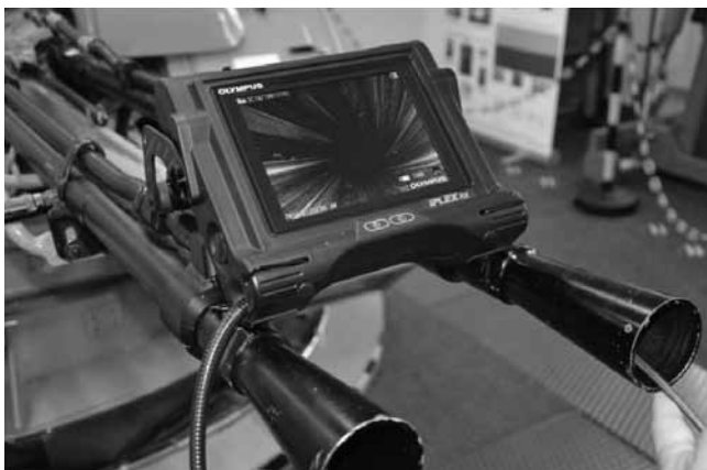
Rys. 2. Wideoskop iPLEX RX podczas badań endoskopowych w PBRiA AMW Fig. 2. Iplex Wideoendoskop RX during endoscopy in PBRiA AMW
