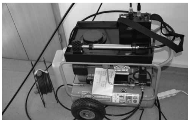
Rys. 4. Urządzenie do czyszczenia przewodu lufy i komory naboju Fig. 4. Device for cleaning the barrel and the chamber
