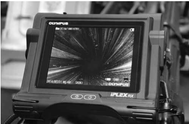
Rys. 5. Rejestracja wideo diagnostyki 23mm lufy ZU-23-2MR wideoskopem iPLEX RX
