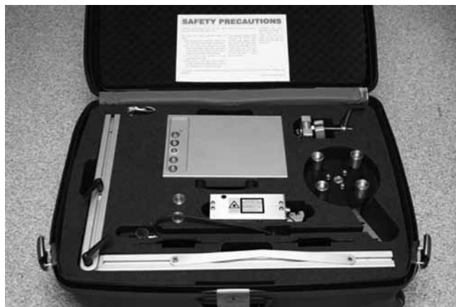
Rys. 2. Przenośny system pomiarowy do wyznaczania równości podłużnej [9]
