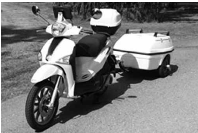
Rys. 4. Urządzenie do pomiarów równości podłużnej chodników i ścieżek rowerowych [9]
