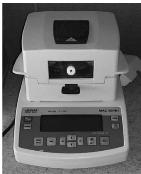
Rys. 1. Aparatura badawcza: a) wagosuszarka, b) miernik dielektryczny Trotec T650
