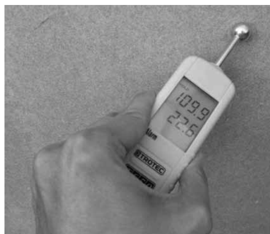
Rys. 1. Aparatura badawcza: a) wagosuszarka, b) miernik dielektryczny Trotec T650
