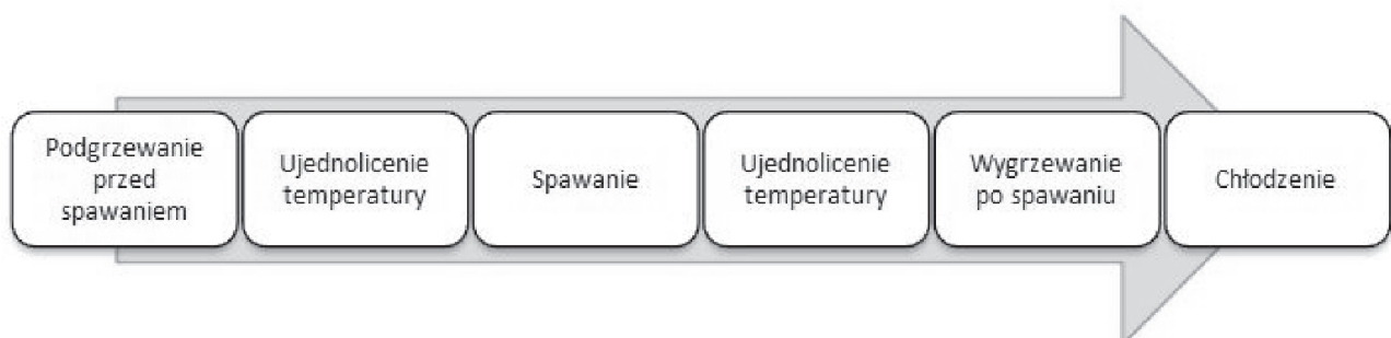
Rys. 2. Schemat procesu spawania hybrydowego z zastosowaniem nagrzewania indukcyjnego [5]
