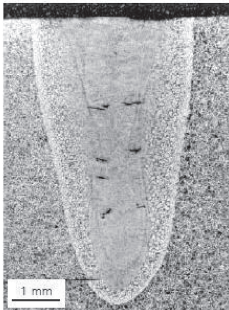
Rys. 1. Pęknięcia na zimno w spoinie stali C45 spawanej promieniem lasera [3]
