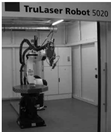
Rys. 1. Stanowisko robota spawalniczego KUKA (źródło: opracowanie własne) Fig. 1. KUKA robot welding workstation (source: own case study)
