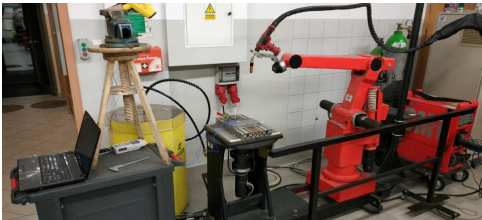
Rys. 2. Stanowisko zrobotyzowane do spawanie metodą MAG
