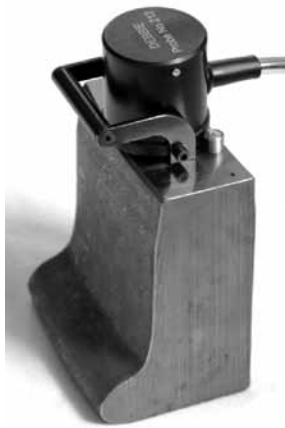
Rys. 1. Blok do kontroli aparatury, wykonany jako wycinek wieńca koła monoblokowego
